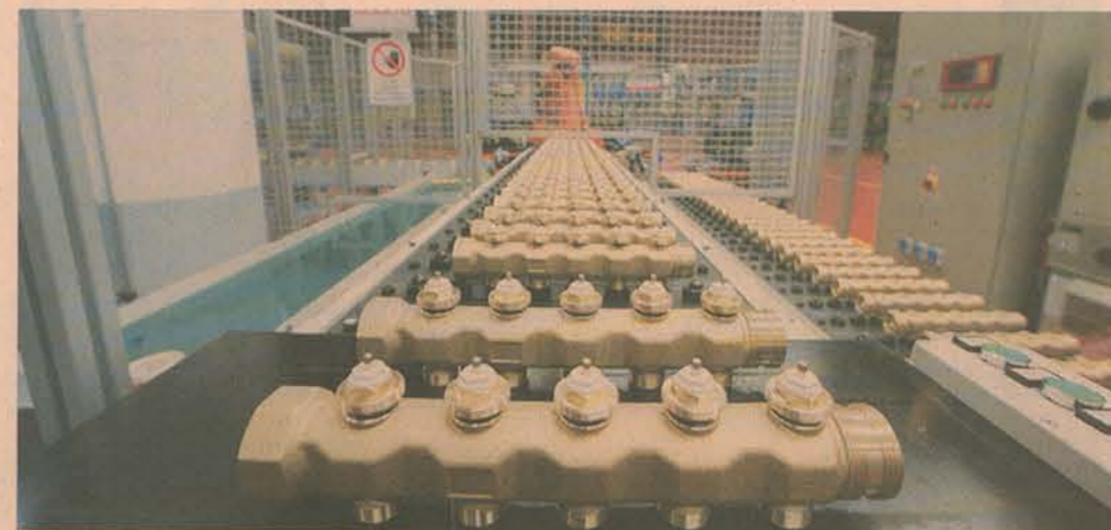
Snodo cruciale. Una fase produttiva, nell'impianto Caleffi di Fontaneto D'Agogna (Novara), di collettori per la distribuzione di acqua calda negli impianti di riscaldamento a pavimento
